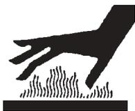
Le cylindre de repassage peut , après utilisation, approcher les 200 °C. (392 °F.) et provoquer des brûlures graves lors d'un contact. Le laisser refroidir avant toute intervention de dépannage ou d'entretien.
