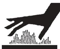
**Pour prévenir le risque de brûlure, le conduit d'évacuation des buées des sècheuses repasseuses à sortie arrière doit obligatoirement être isolé thermiquement (fourniture client).**
