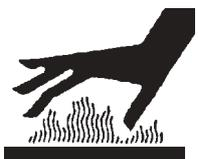
Ce symbole prévient l'utilisateur de la présence de hautes températures pouvant provoquer des brûlures graves. Certaines surfaces peuvent approcher les 200 °C. (392 °F.).
